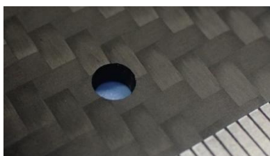
図 CFRPクロスプライ積層板に対する穴加工例
